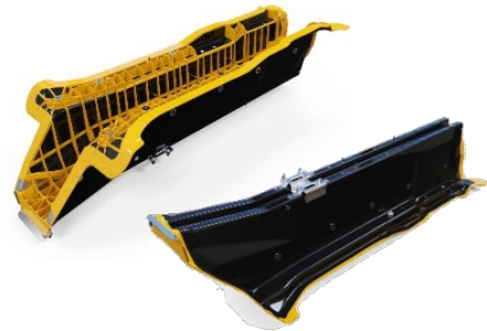
Der Mitteltunnel in Hybridbauweise mit glasfaserverstärkter Rippenstruktur als CAD-Darstellung. Bildnachweis: Porsche, VW, TU Braunschweig.
