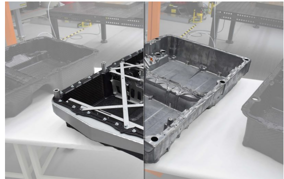
Das im Projekt „ProVorPlus“ entwickelte Batteriegehäuse in faserverstärkter Kunststoff-Metall-Hybridbauweise. Bei identischen Kosten und gleicher Stabilität können mit diesem Produktionsverfahren bis zu 20 Prozent des Bauteilgewichts eingespart werden. Bildnachweis: IWF/TU Braunschweig.
