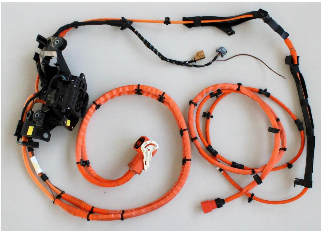
Abbildung 1: Beispielhafter Hochvolt-Teilleitungssatz mit Ladebuchse im Neuzustand (Foto: N. Langmaack)
